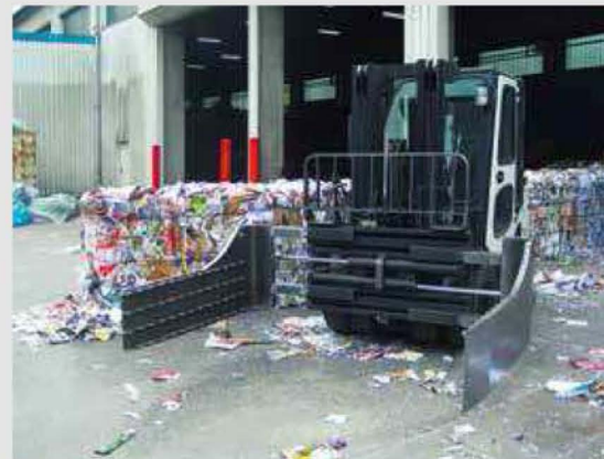
Zusätzliche Rippen verhindern ein Durchrutschen der Ballen.
