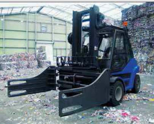
Typische Großklammer für Stapler der 6-t-Klasse.
