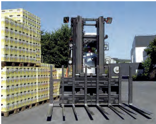
Aufnahme von 8 Paletten Leergut bzw. 6 Paletten Vollgut Gabelstapler: 8,0 to/900 mm LSP bzw. 9,0 – 10,0 to/600 mm LSP
