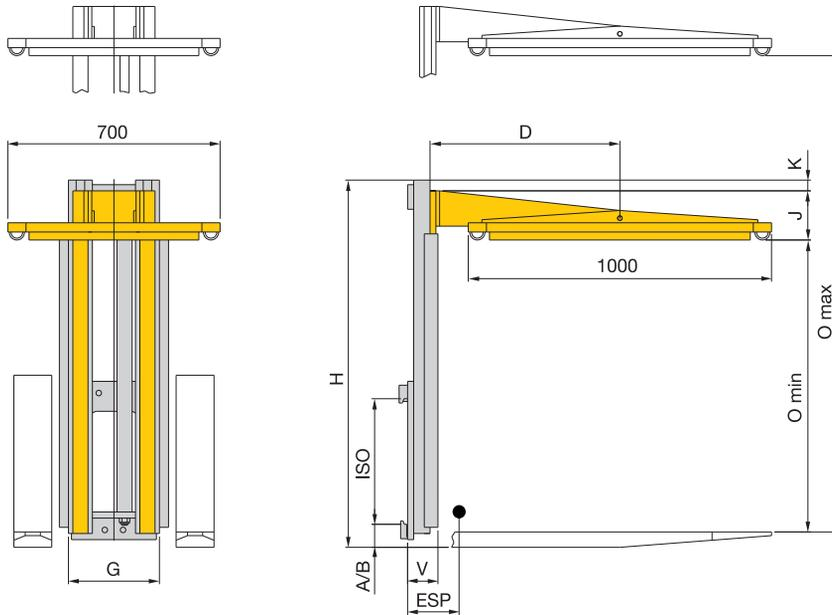
Druckrahmen pendelnd, Kontaktfläche mit Hohlgummischlauch
