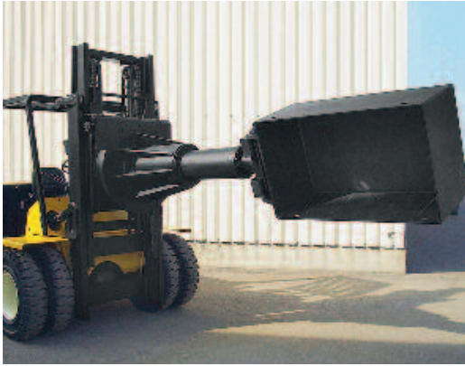
Chargierichtung mit hydraulischer Muldenverriegelung
