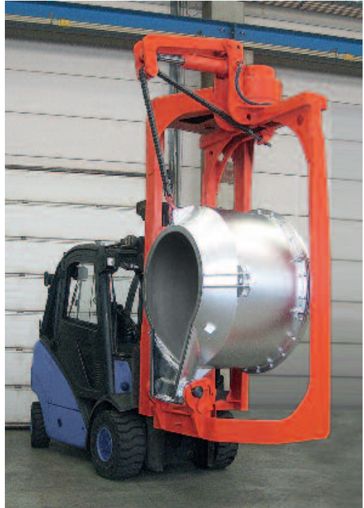
Gießtiegelkippergerät mit Tiegel
