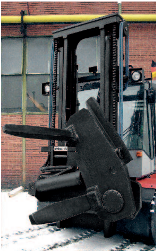
Integrierte Seitenkippvorrichtung mit Seitenschub
