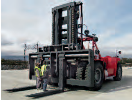
Zinkenverstellung – Tragfähigkeit 55.000 kg / 1200 mm
