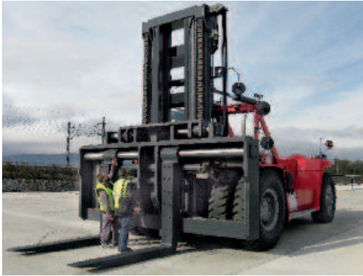
Zinkenverstellung – Tragfähigkeit 55.000 kg / 1200 mm
