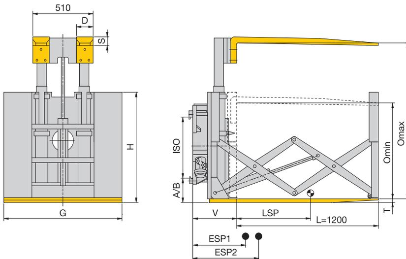
Abschublänge 1200 mm · inkl. Magnetventil · Drehbereich 360°
