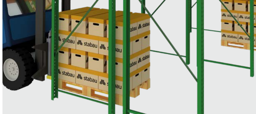
DOPPELTIEFE EINLAGERUNG EINGEFAHREN
